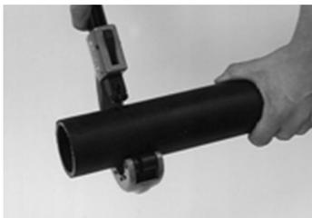
Ровно отрезаем трубу специальным инструментом (труборез, ножовка, пила).
