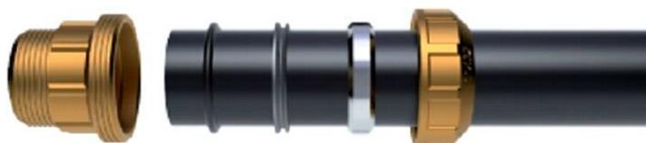
**Монтаж фитинга.** Наденьте на трубу зажимную гайку и обжимное кольцо. Вставьте конец трубы в фитинг, стараясь не оторвать уплотнительное кольцо с места.
