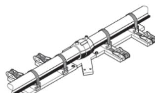
Снимите фиксирующее приспособление и можете приступить к испытаниям соединения.
