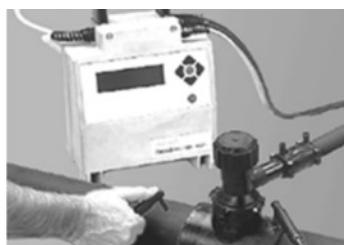
После окончания цикла сварки снимите наконечники и выждите время остывания, которое отображено на фитинге.
