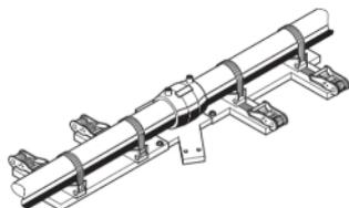
Жестко зафиксируйте трубы в фитинге с соблюдением соосности.
