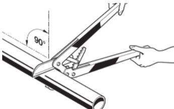
Ровно отрежьте трубу перпендикулярно продольной оси специальным инструментом (труборез, ножовка, пила).
