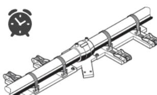
После окончания цикла сварки разъедините провода и выждите время остывания, которое отображено на фитинге.
