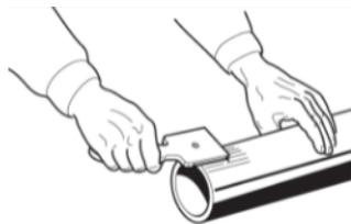
Снимите оксидный слой с трубы с помощью зачистного устройства. **(НЕ ИСПОЛЬЗОВАТЬ АБРАЗИВНЫЙ ИНСТРУМЕНТ)**
